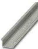
Carril simétrico sin perforar, Perfil estándar 2,3 mm, anchura: 35 mm, altura: 15 mm, según EN 60715, material: Acero, galvanizado, pasivado de capa gruesa, longitud: 2000 mm, color: plateado
