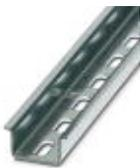
Carril simétrico perforado, Perfil estándar, anchura: 35 mm, altura: 15 mm, similar EN 60715, material: Acero, Galvanizado, pasivado blanco, longitud: 2000 mm, color: plateado
