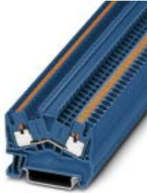
Borne de paso, tensión nominal: 800 V, corriente nominal: 24 A, tipo de conexión: Conexión push-in, número de conexiones: 2, sección: 0,14 mm<sup>2</sup> - 4 mm<sup>2</sup>, AWG: 26 - 12, anchura: 5,2 mm, color: azul, clase de montaje: NS 35/7,5, NS 35/15
