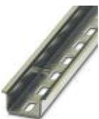
Carril simétrico perforado, Perfil estándar, anchura: 35 mm, altura: 15 mm, similar EN 60715, material: Acero, galvanizado, pasivado de capa gruesa, longitud: 2000 mm, color: plateado
