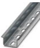
Carril simétrico perforado, Perfil estándar, anchura: 35 mm, altura: 15 mm, similar EN 60715, material: Acero, galvanizado, longitud: 2000 mm, color: plateado
