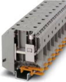
Borne de corriente, tipo de conexión: Conexión por tornillo, número de conexiones: 2, sección: 25 mm<sup>2</sup> - 95 mm<sup>2</sup>, AWG: 4 - 3/0, anchura: 25 mm, altura: 90 mm, color: gris, clase de montaje: NS 35/15, NS 32
