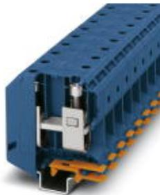
Borne de corriente, tipo de conexión: Conexión por tornillo, número de conexiones: 2, número de polos: 1, sección: 25 mm<sup>2</sup> - 95 mm<sup>2</sup>, AWG: 4 - 3/0, anchura: 25 mm, altura: 90 mm, color: azul, clase de montaje: NS 35/15, NS 32, NS 35/15-2,3
