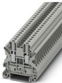
Borne de paso, tipo de conexión: Conexión por tornillo, número de conexiones: 2, sección: 0,14 mm<sup>2</sup> - 6 mm<sup>2</sup>, AWG: 26 - 10, anchura: 6,2 mm, altura: 46,9 mm, color: gris, clase de montaje: NS 35/7,5, NS 35/15
