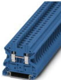
Borne de paso, tipo de conexión: Conexión por tornillo, número de conexiones: 2, sección: 0,14 mm<sup>2</sup> - 6 mm<sup>2</sup>, AWG: 26 - 10, anchura: 6,2 mm, altura: 46,9 mm, color: azul, clase de montaje: NS 35/7,5, NS 35/15
