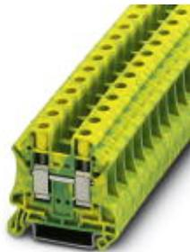
Borne de tierra para carril, tipo de conexión: Conexión por tornillo, número de conexiones: 2, sección: 0,5 mm<sup>2</sup> - 16 mm<sup>2</sup>, AWG: 20 - 6, anchura: 10,2 mm, altura: 46,9 mm, color: amarillo-verde, clase de montaje: NS 35/7,5, NS 35/15
