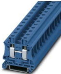
Borne de paso, tipo de conexión: Conexión por tornillo, número de conexiones: 2, sección: 0,5 mm<sup>2</sup> - 16 mm<sup>2</sup>, AWG: 20 - 6, anchura: 10,2 mm, altura: 46,9 mm, color: azul, clase de montaje: NS 35/7,5, NS 35/15
