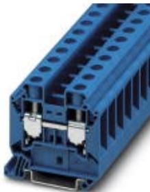
Borne de paso, tipo de conexión: Conexión por tornillo, número de conexiones: 2, sección: 1,5 mm<sup>2</sup> - 25 mm<sup>2</sup>, AWG: 16 - 4, anchura: 12,2 mm, altura: 54,4 mm, color: azul, clase de montaje: NS 35/7,5, NS 35/15
