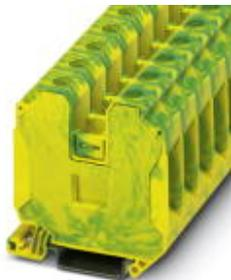
Borne de tierra para carril, tipo de conexión: Conexión por tornillo, número de conexiones: 2, sección: 1,5 mm<sup>2</sup> - 35 mm<sup>2</sup>, AWG: 16 - 2, anchura: 16 mm, altura: 65,1 mm, color: amarillo-verde, clase de montaje: NS 35/7,5, NS 35/15
