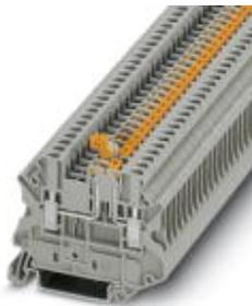
Borne interrumpible por cuchilla, tensión nominal: 400 V, corriente nominal: 20 A, tipo de conexión: Conexión por tornillo, sección: 0,14 mm<sup>2</sup> - 4 mm<sup>2</sup>, AWG: 26 - 12, longitud: 57,8 mm, anchura: 5,2 mm, color: gris, montaje: NS 35/7,5, NS 35/15
