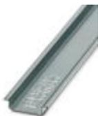
Carril simétrico sin perforar, Perfil estándar, anchura: 35 mm, altura: 7,5 mm, según EN 60715, material: Acero, Galvanizado, pasivado blanco, longitud: 2000 mm, color: plateado
