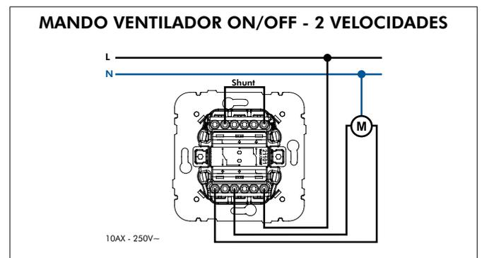
MEC 21 - ESQUEMAS DE CONEXIÓN
