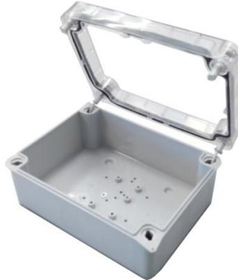
Caja fabricada en policarbonato resistente a 960 °C según norma UNE-20672-2-1/1, color gris RAL 7035. Tapa de policarbonato transparente o gris RAL 7035, con latiguillos plásticos de fijación a la caja. Grado de protección IP-55.
