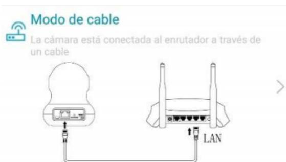
Conecte la cámara mediante un cable de red Ethernet **al router de la instalación** y pulse siguiente.
